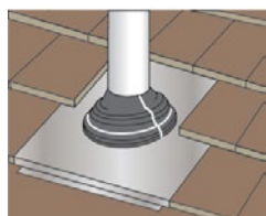
EPDM Beslag Installasjon
